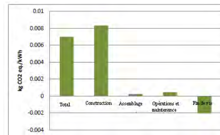
Figure 46. Contributions de chaque étape du cycle de vie au potentiel de réchauffement global
