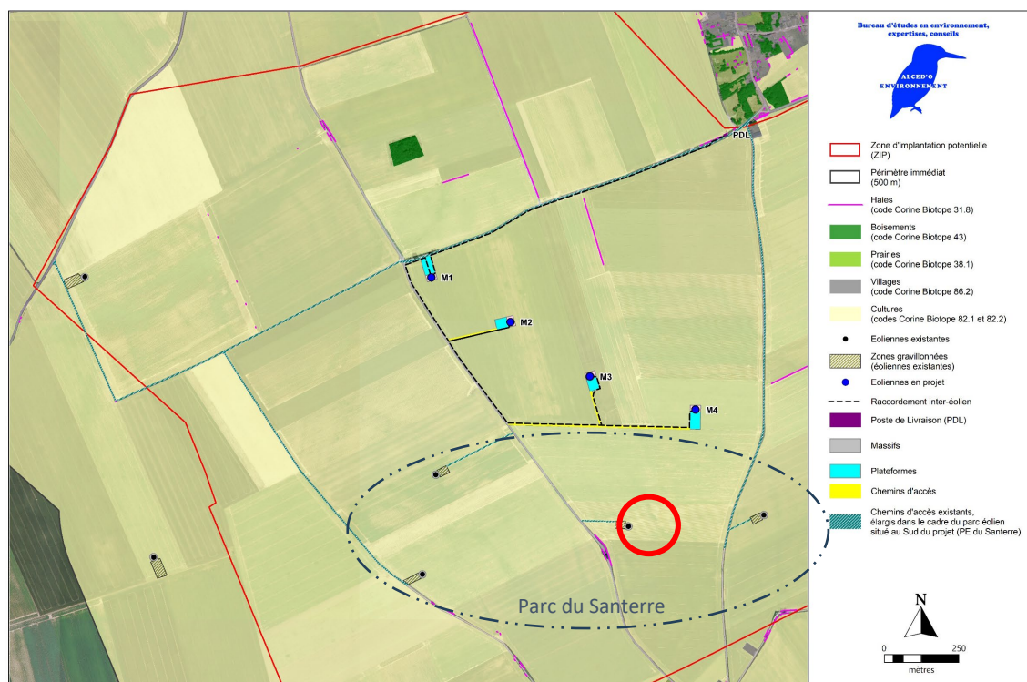
Figure 29 : Zoom sur les créations de chemins d'accès et de plateformes du parc du Bois Merlu - phase exploitation
