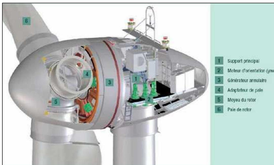
**Figure 16 : Dessin schématique de la nacelle**
