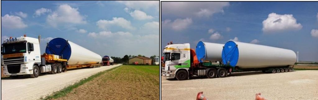
**Figure 15 : Exemple de transport des éoliennes (source : BURGEAP)**
