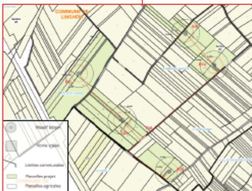
5 éoliennes Enercon E101 - 3.05 MW (rotor de 100m, mât de 99m, hauteur totale 150m) sur la commune de Linghem
