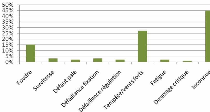
Figure 15 - Répartition des causes premières de rupture de pale, SER-FEE 2012
