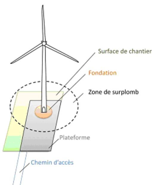
Figure 9 - Illustration des emprises au sol d'une éolienne
