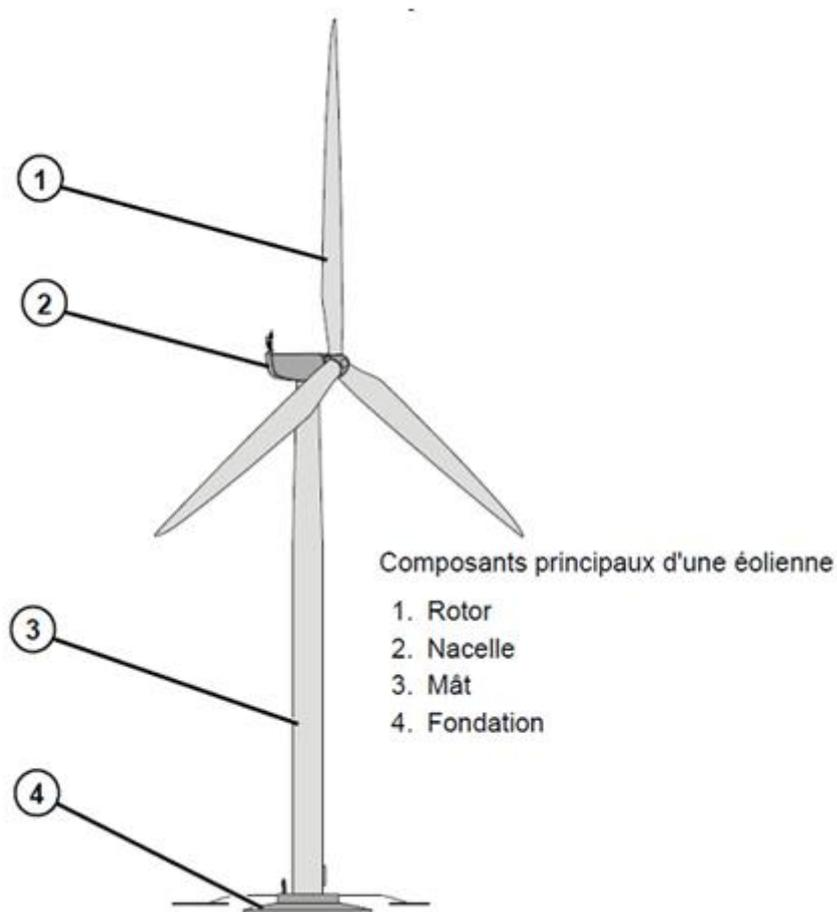
**Figure 8 - Dénomination des différents éléments d'une éolienne**
