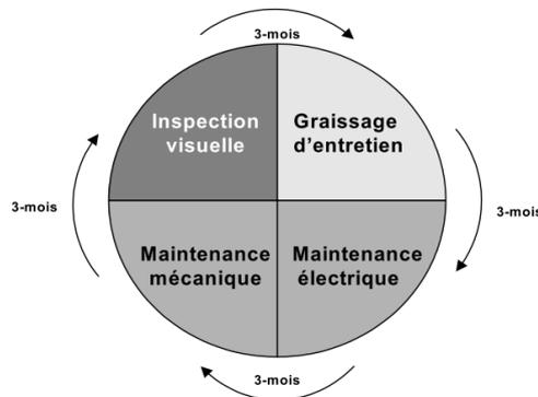
**Figure 10 - Phases de maintenance**
