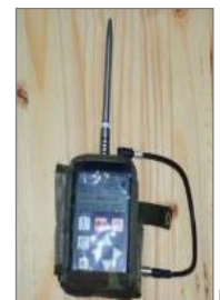
Figure 64 : Détecteur d'ultrasons et enregistreur manuel Petterson® D1000x (a) et Détecteur d'ultrasons et enregistreur automatique EcoObs® Batcorder (b)
