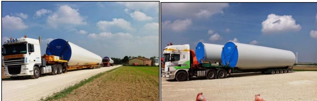
**Figure 18 : Exemple de transport des éoliennes (source : BURGEAP)**
