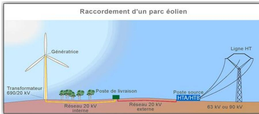
**Figure 9 : Organisation générale du raccordement électrique au réseau de distribution**
