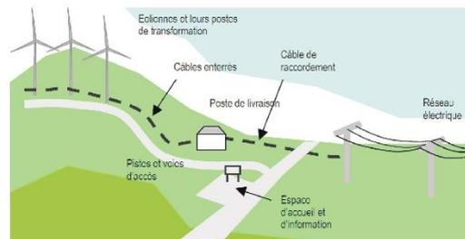
La vitesse du vent nécessaire au démarrage d'une éolienne est de l'ordre de 4m/s, soit 12 km/h. Elle monte ensuite progressivement en puissance pour atteindre sa puissance nominale (2MW) à 11 m/s (40km/h). Au-delà de 25m/s (90km/h) l'éolienne est progressivement arrêtée pour sécuriser les équipements et minimiser l'usure.
