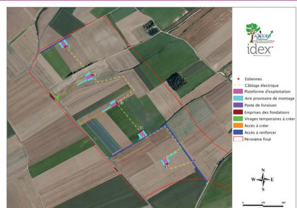
Figure 4 - Localisation des structures à implanter
